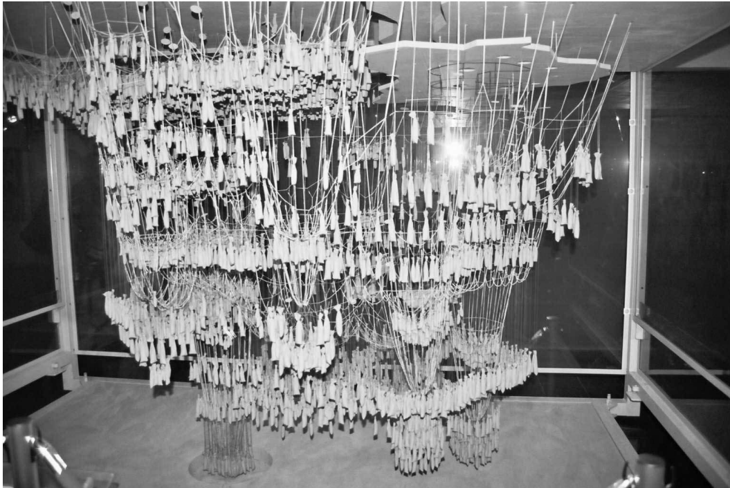
Fig. 9.26 Model funicular de l'església de la Colònia Güell
